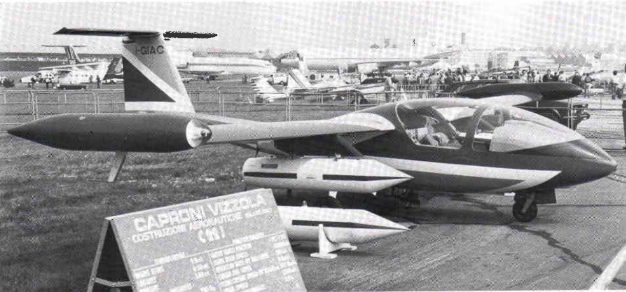
I den lättare klassen visades det italienska Caproni C22J Vizzola, drivet av två Microturbo-motorer.
