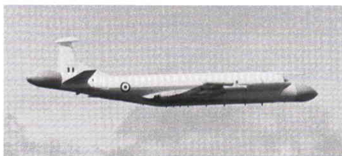
Två intressanta flygplan som endast visades i luften var tankningsflygplanet VC-10K.2 samt den flygburna radarstationen Nimrod AEW med nos- och stjärtmonterade antenner för 360° täckning.
