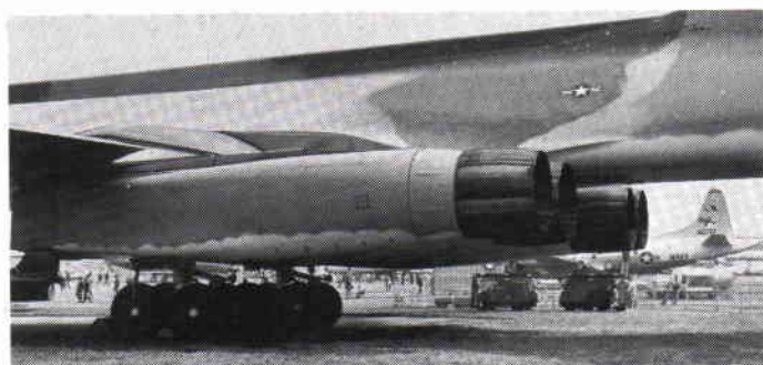
Fyra mäktiga F101-motorer driver superbombflygplanet B-1.
