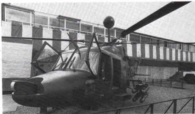
Westland Lynx 3 i fullskalemodell med Martin-Marietta's mast- och nosmonterade målinmätningssystem samt med pansarvärnsrobot av Hellfire-typ.
